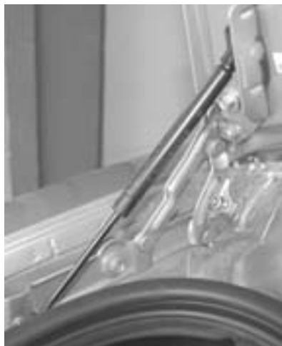
b) Mecanismo de apertura de cajuela
